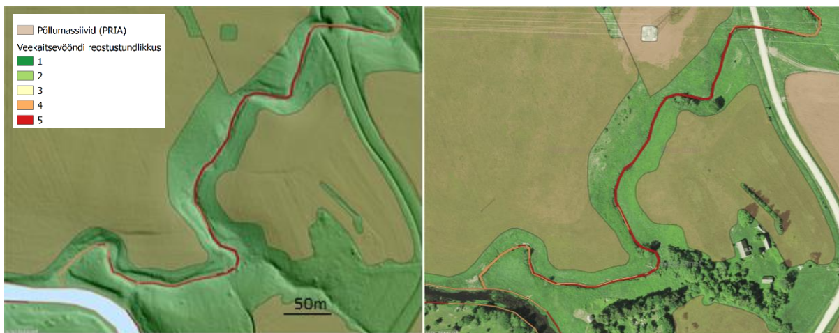
Joonis 24. Näide alast (Räägu oja Pärnumaal), kus mulla- ja reljeefitingimustest tulenevalt on reostustundlikkus ehk reostusohu tase kõrge ja kaldavööndis kõrgem taimkate peaaegu puudub. Vasakul reljeefivarjutus ja paremal ortofoto. Aluskaart: Maa-amet, 2021.
